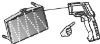
прибора будет отображаться текущая температура, а в дополнительном поле максимальная или минимальная зафиксированная температура. После окончания измерения отпустите курок, измеренные значения зафиксируются – режим «HOLD». При следующем нажатии курка начнётся новое измерение – предыдущие измеренные значения сбросятся.
