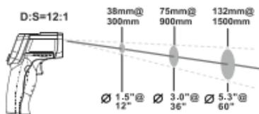
зависимости от размера измеряемого объекта выберите расстояние до него.
